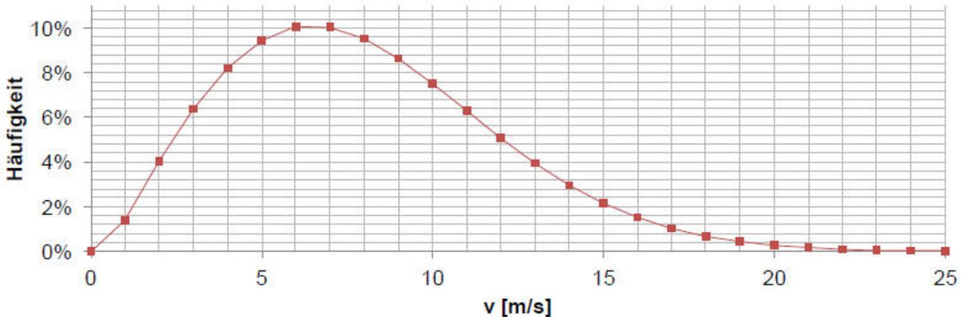
Abbildung 10: Berechnete Häufigkeitsverteilung der Windgeschwindigkeit für Klasse III nach der Rayleigh-Verteilung.
