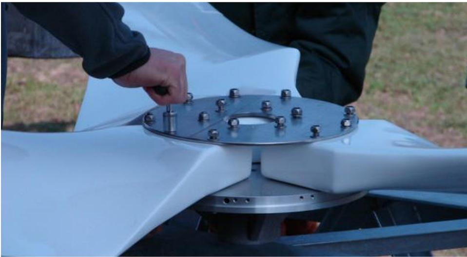
Befestigen Sie nun die Rotorblätter an der Aluminiumnabe. Achten Sie darauf, dass die hohle Seite der Blätter nach vorn (in Windrichtung) zeigt. Schrauben Sie nun die Blätter mit den mitgelieferten Schrauben leicht an. Justieren Sie die Blätter so, dass sie von Blattspitze zu Blattspitze den gleichen Abstand zueinander haben. Schrauben Sie die Blätter nun fest.
