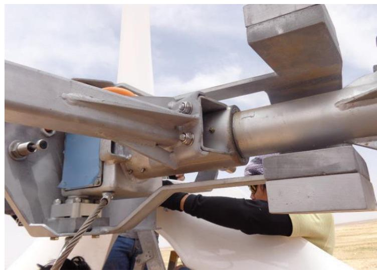
Abbildung 5: Mit dem Maschinenträger verschraubten Rohr zur Windfahne. Die 4 Stück Schrauben M12 werden mit 50 Nm angezogen.
