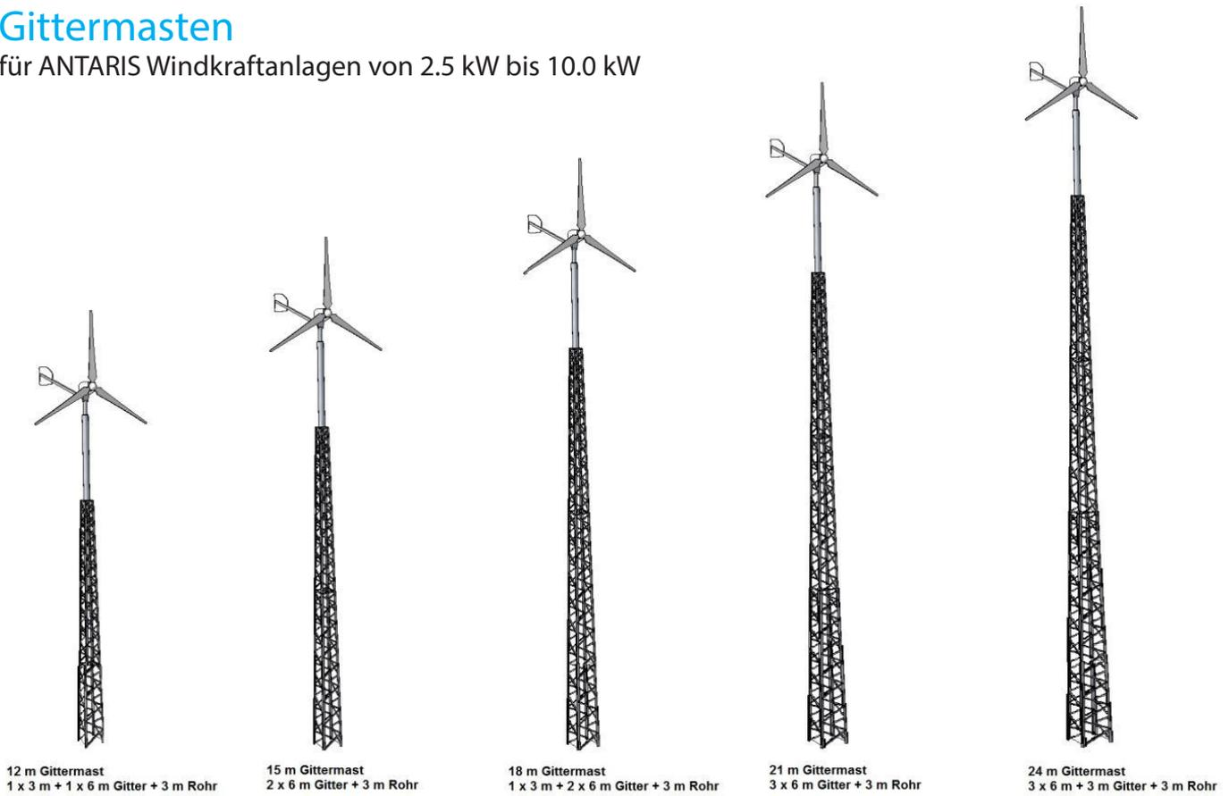
Bild 9: Gittermasten (von 12m bis 24m)
